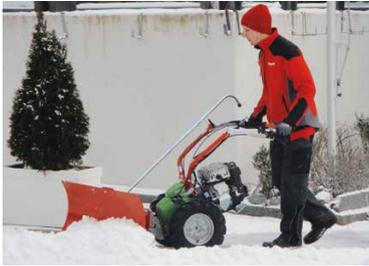
Rapid Räumschilde zeichnen sich durch ihre Vielseitigkeit, Sicherheit und einfache Bedienung aus. Mit dem vom Holm aus bequem bedienbaren Schwenkmechanismus wird Schnee effizient in die gewünschte Richtung weggeschoben. Dank werkzeuglos montierbaren Seitenblechen ist rückstandsloses Räumen von grösseren Flächen möglich.
